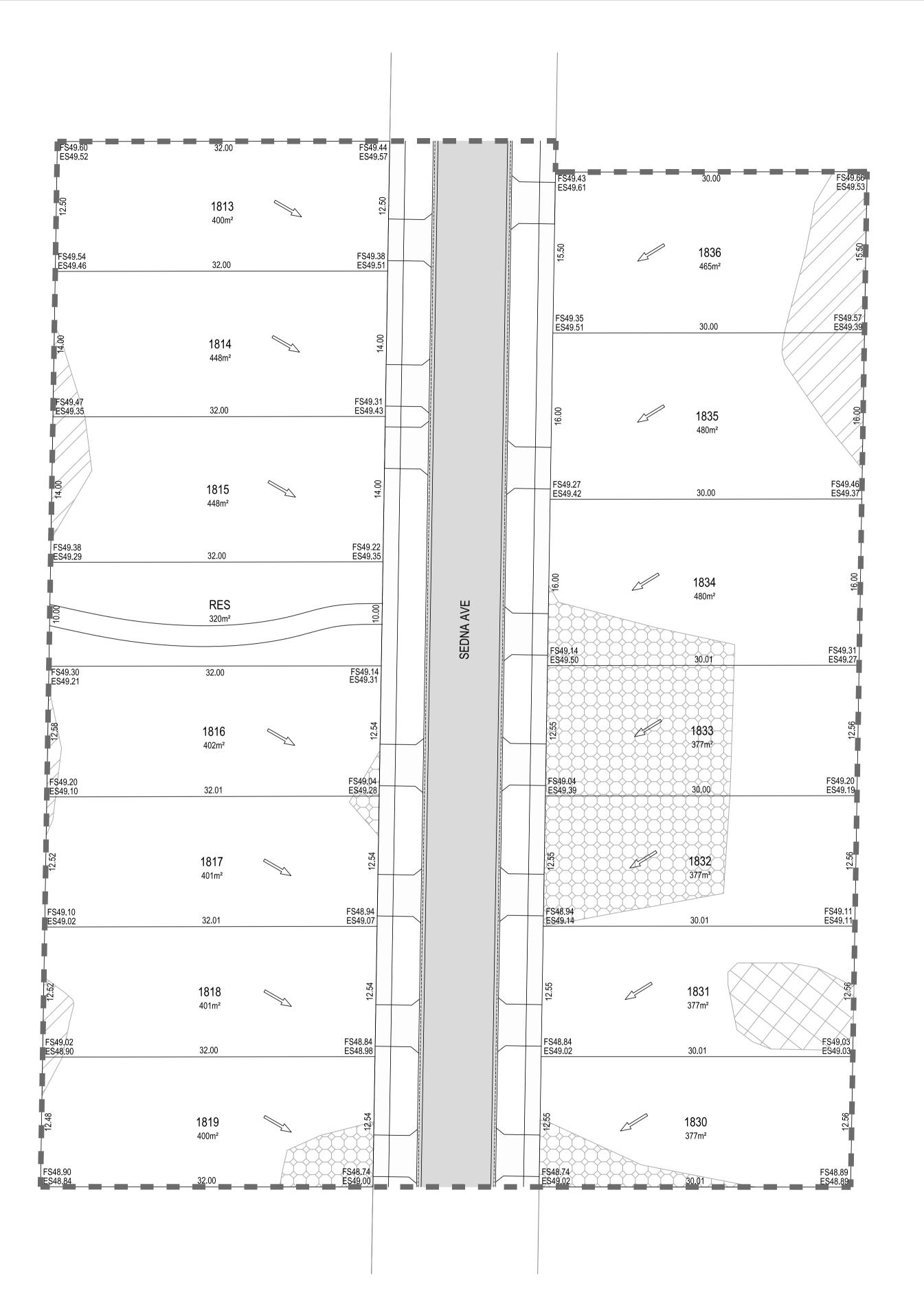
STAGE BOUNDARY FILL 300 - 600 FS99.99 FINISHED SURFACE LEVEL ES99.99 EXISTING SURFACE LEVEL CUT/FILL HATCHING ASSUMES TOPSOIL
