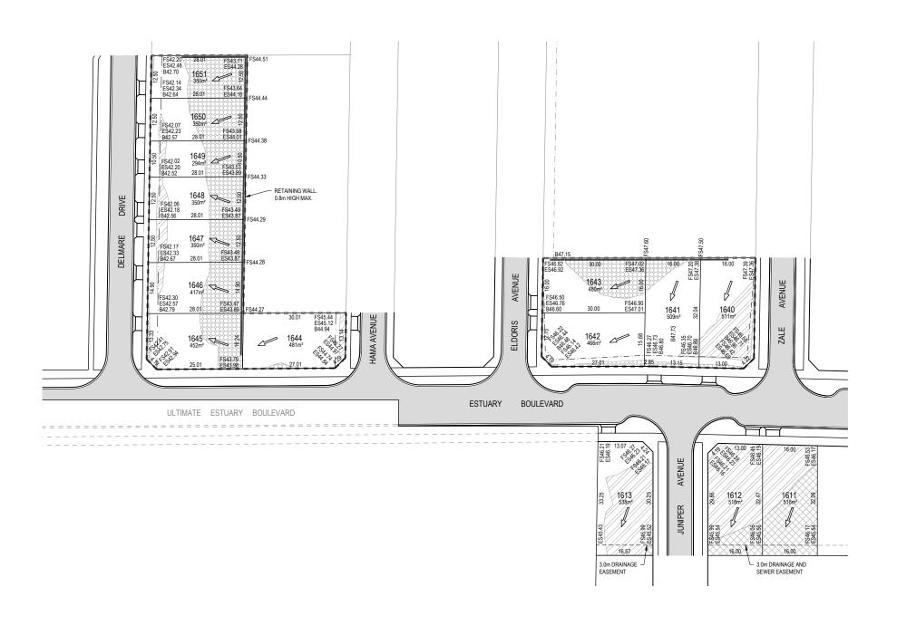
LEGEND LOT FALL CUT FILL 900 - 1000 LOW RETAINING WALL (0.2-0.5m) --- EASEMENT ---- BATTER LINE B99.99 BATTER LEVEL FS99.99 FINISHED SURFACE LEVEL ES99.99 EXISTING SURFACE LEVEL
