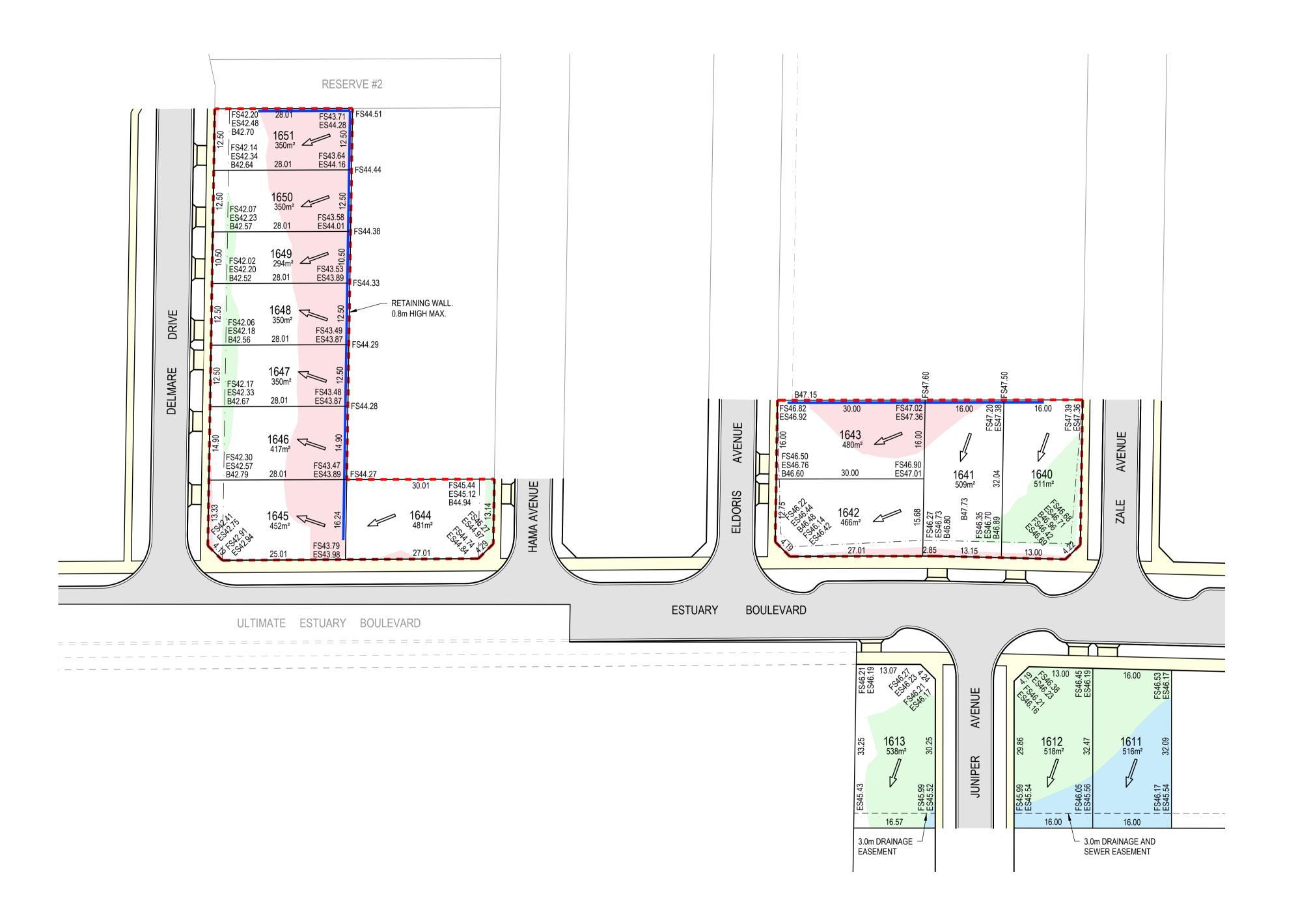
**LEGEND - - -** STAGE BOUNDARY FILL 300 - 600 FILL 600 - 900 FILL 900 - 1000 PROPOSED RETAINING WALL ——— EASEMENT — · — BATTER LINE B99.99 BATTER LEVEL FS99.99 FINISHED SURFACE LEVEL ES99.99 EXISTING SURFACE LEVEL
